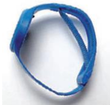
Figuur 2: Wijze waarop de uiteinden van de dosismeter in elkaar worden gestoken.
