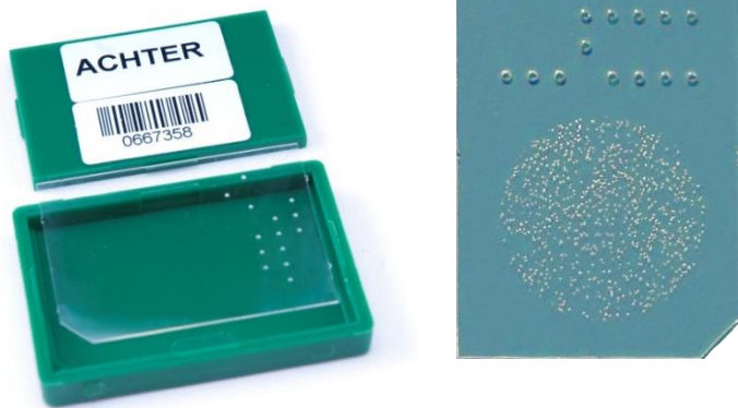
Figuur 3: Geopende PADC-dosimeter met folie links, en rechts een voorbeeld van een geëtste folie.
