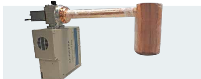
電気冷却機構と銅製クライオスタット (特注)を備えたPCGe検出器
