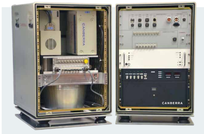
2つのキャビネット（検出器と処理電子機器）で構成されるMirion製空中システムのハードウェア概要
