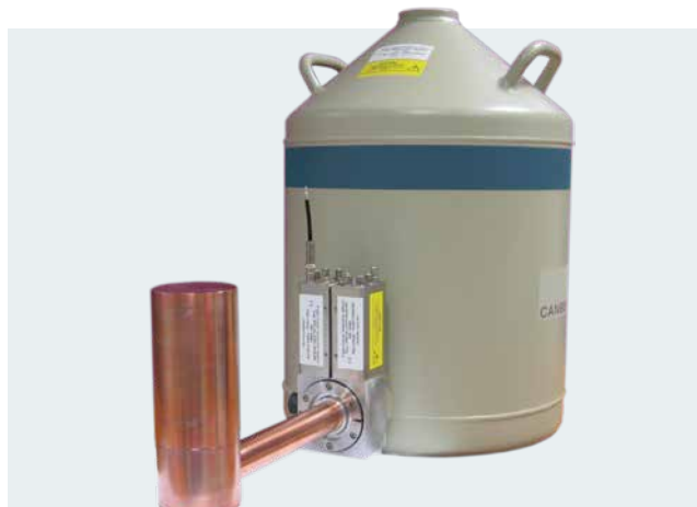
両方の検出器接点に読み出しプリアンプを備えたPCGe検出器
