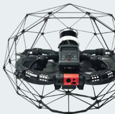
飛行中に取得したデータで、放射線を可視化し3Dマップを作成
