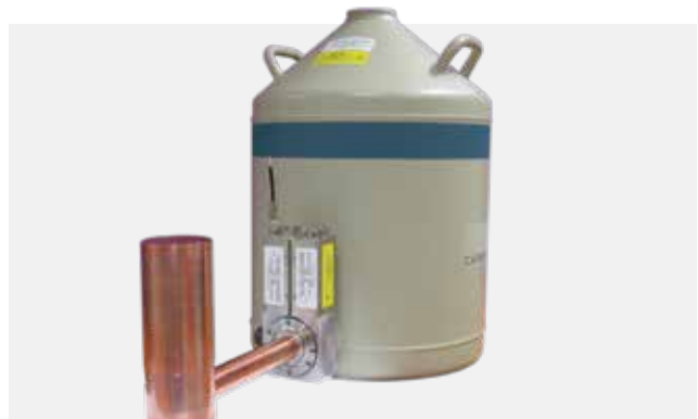
両方の検出器接点に読み出しプリアンプを備えたPCGe検出器
