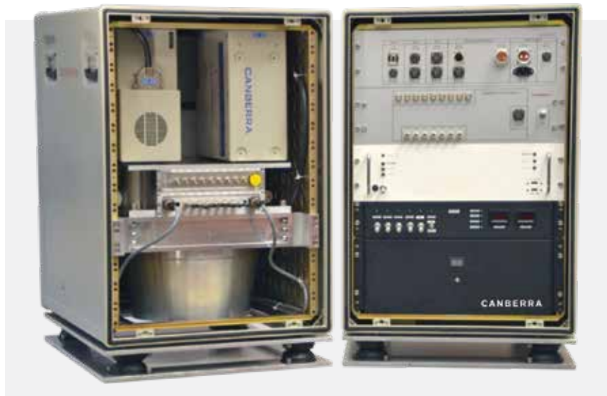
2つのキャビネット（検出器と処理電子機器）で構成されるMirion製空中システムのハードウェア概要
