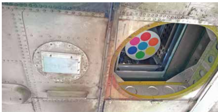
航空機のキャビンの穴からの検出器キャップのビュー。色付きの各円は、共通のクライオスタット内の個々の同軸検出器の位置を示しています
