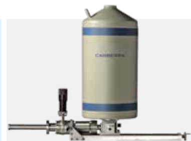
GUL検出器 (有効面積100 mm 2 ) およびウィンドウレスリトラクタブル クライオスタット (オプション)
