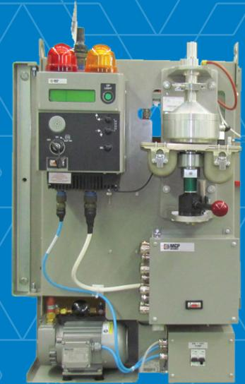
**Surveillance de l'air extrait des conduits de ventilation et des cheminées.**
