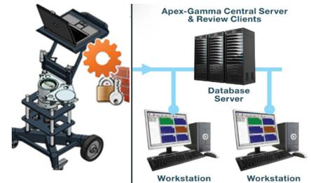
Figure 30 – Exemple d'application de Genie-Fieldpro pour transférer automatiquement les spectres et les résultats des échantillons vers une application Apex-Gamma distante pour le post-traitement, la réanalyse et le stockage des données.
