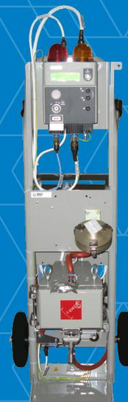
Mesure en continu de l'activité volumique gamma de l'iode radioactif présent dans les gaines de ventilation, les cheminées, les zones de travail.
