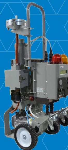
**Compact, léger et mobile pour mesurer l'activité volumique gamma de l'iode radioactif.**
