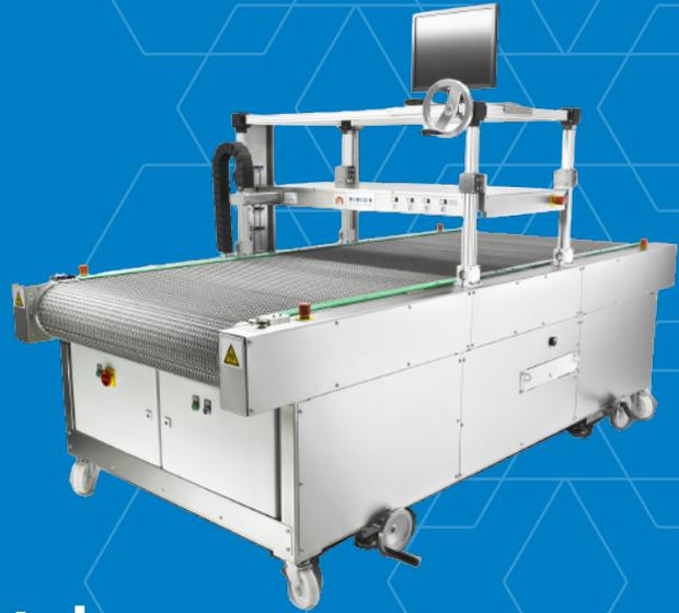
Détection et à la mesure de la contamination sur les vêtements et les petits objets comme des vannes ou tuyaux.
