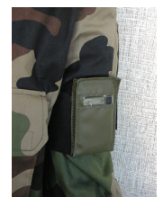
Dosimètre SOR porté à l'intérieur d'une pochette
