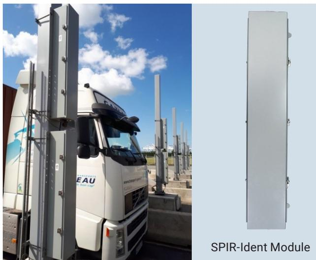
Une structure de portique de détection se compose de plusieurs modules gamma installés sur une structure verticale et connectés à un commutateur "Power over Ethernet" (PoE) et à un poste d'alarme local.
